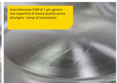
Una tolleranza CAM di 1 µm genera una superficie di buona qualità senza allungare i tempi di lavorazione.
